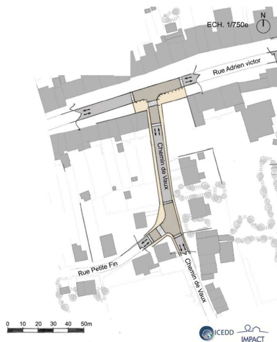
PROPOSITION D'AMENAGEMENT PAR VILLAGE : MUSSON - CARREFOURS SECURISES (PLATEAUX)
